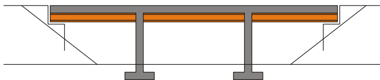
Figur 1-10: Kontinuerlig bro med semi-integrerade landfästen
