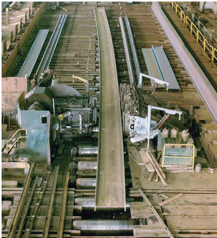
Figur 14-1: Överhöjning av stålbealkar, slutprodukt (Hechler, 2010)
